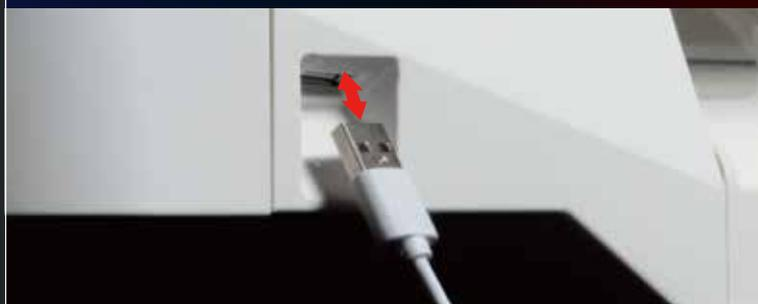
全席にType A規格のUSBポートを搭載しています。省電力設計により同時に使用できるのは2ポートまでです。
